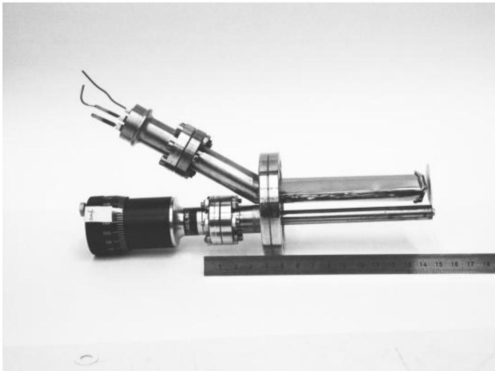
*Abbildung 7.2: Zinkverdampfer mit Abschirmung und Shutter.*
