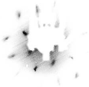
Abb. 4.11: Invertiertes LEED-Bild der ZnSe c(2 \times 2) -rekonstruierten Oberfläche bei einer Primärenergie von 45 eV
