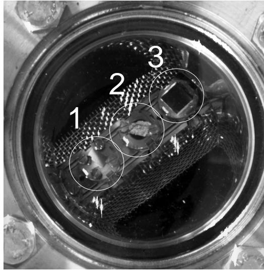
Abbildung 3.2: Blick durch das Fenster in den UHV-Koffer, der zum Transport der Proben zu den Messungen bei BESSY diente. Gut sichtbar sind die auf ihren Haltern aufgeschraubten Inlays: (1) eine mit Tantal-Bleichen geklemmte BeTe/Si-Probe, (2) ein Inlay mit Gold-Folie, die zur Energiekalibrierung der Meßapparatur diente, und (3) eine mit Indium geklebte ZnSe/GaAs-Probe.
