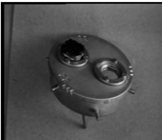
Abbildung 2.4: Modifizierter Zwei-Zoll-Halter der MBE mit und ohne Probeninlay.
