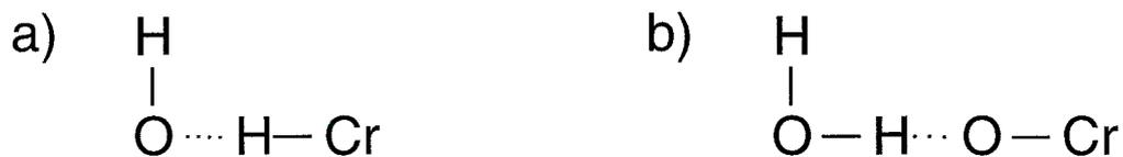
**Abbildung 6.4:** Zwei mögliche Bindungsmodelle zur Erklärung der O 1s XPS Spektren für 1 und 1,5 ML Cr auf 1 BL Wasser nach Temporn auf 250 K
